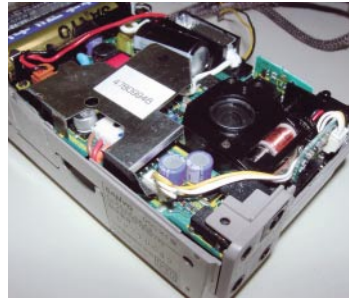
OS-CON搭載 10V/47 \mu F \times 2P サイズ \phi 6.3 \times L5.0
