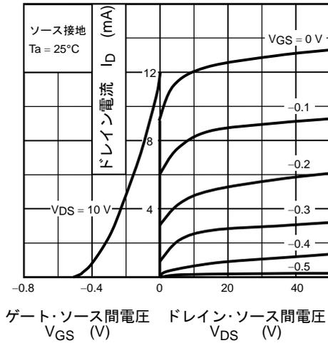
$I_D - V_{DS}$  (低電圧領域)
